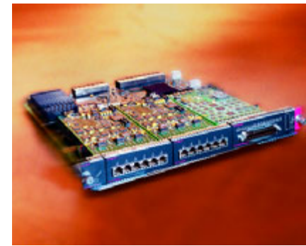
Abbildung 32: Cisco 6500 Communication Media Module für die Kopplung an TK-Anlagen und Amt
