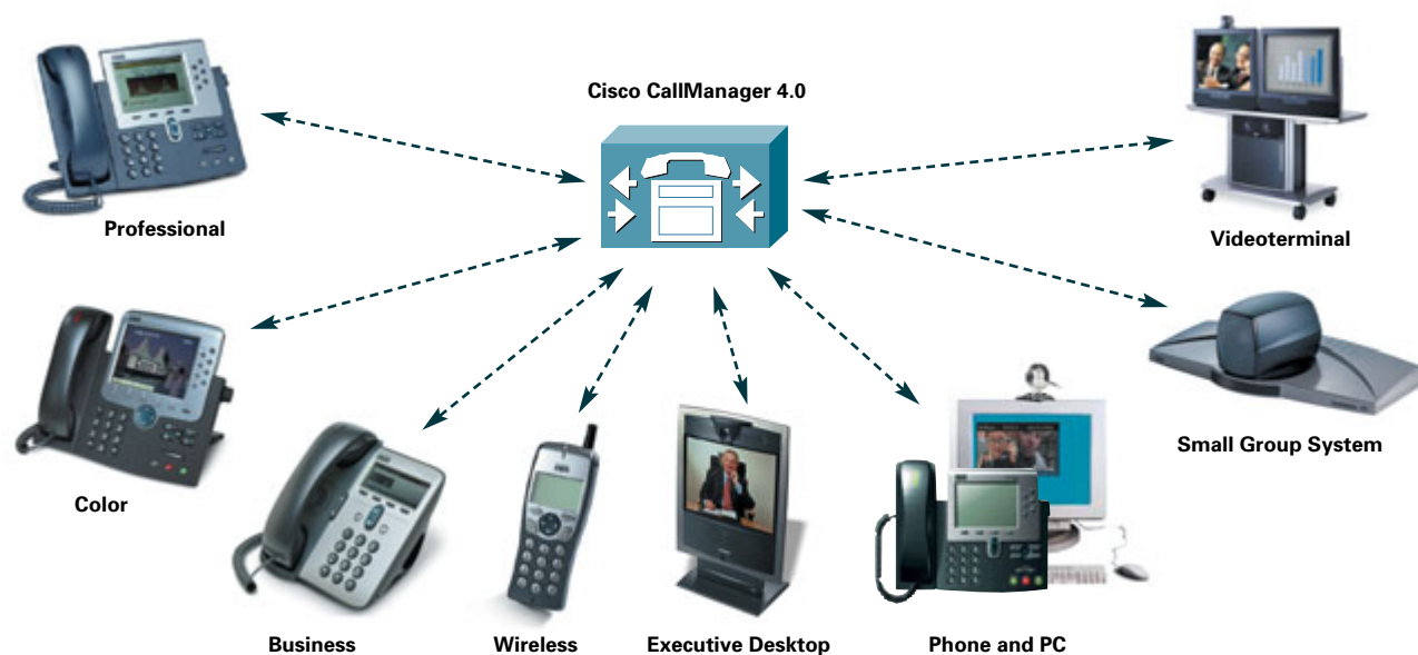
Abbildung 11: Direkte Kopplung Cisco CallManager 4.0 – Videokomponenten
